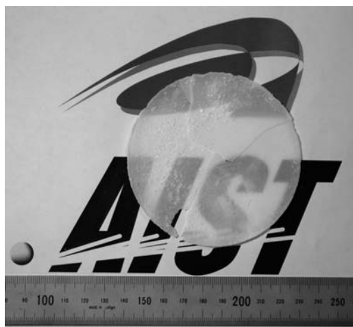
図1 AFI 型ゼオライト配向自立膜。スケールの単位は mm。
