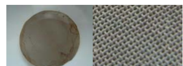
図 4. Cu 金網上モルデナイトコートの耐水性 (左: 浸水中, 右: 乾燥後の金網表面)
