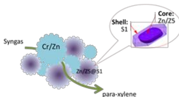
図 3 合成ガスから一段で PX を合成する：メタノール合成触媒とカプセル触媒の連携プレー
