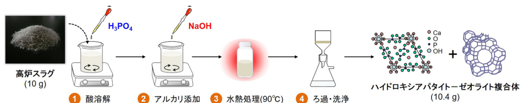
Fig. 2. 高炉スラグを原料としたハイドロキシアパタイト-ゼオライト複合体 (HAP-ZE) の合成スキーム
