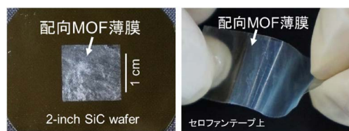
図 11. SiC 基板、プラスチック (セロファンテープ) 上に形成した \text{Cu}_2(\text{BDC})_2 MOF 配向薄膜
