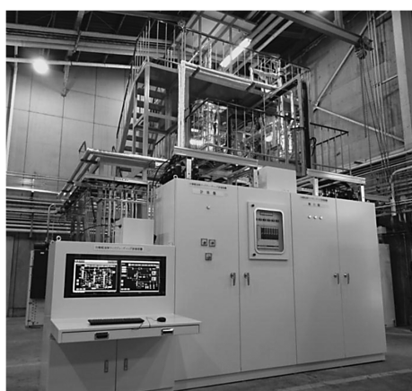
図7 循環流動床型 反応評価装置
