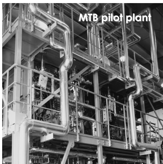
図9 牛の糞尿から得られるバイオガスをういてベンゼンと水素を製造するバイオMTB実証試験プラント（20～50 kg 触媒規模、750～800℃、0.1～0.3 MPa）の概観（北海道開発土木研究所別海有機資源循環利用施設、2003～2007）
